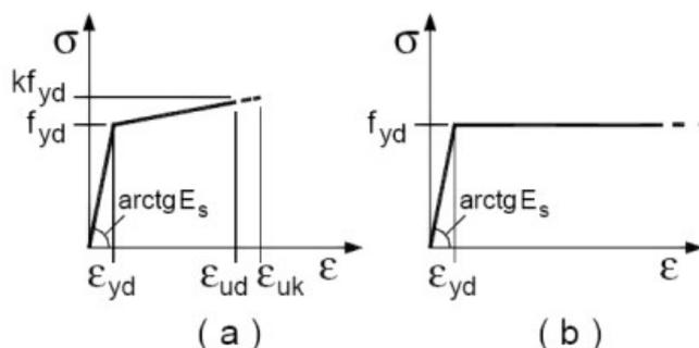
Per il calcolo della capacità di **elementi/meccanismi duttili** o **fragili** si impiegano le proprietà dei materiali esistenti (resistenze medie ottenute dalle prove in situ e da informazioni aggiuntive) divise per i fattori di confidenza in relazione al livello di conoscenza raggiunto.
