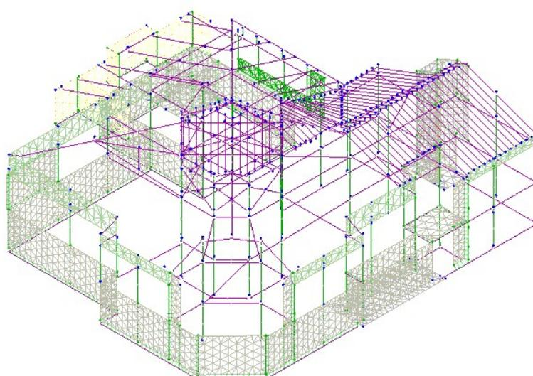
Dalle illustrazioni precedenti si evince come le aste, sia travi che pilastri, siano schematizzate con un tratto flessibile centrale e da due tratti (braccetti) rigidi alle estremità. I nodi vengono posizionati sull'asse verticale dei pilastri, in corrispondenza dell'estradosso della trave più alta che in esso si collega. Tramite i braccetti i tratti flessibili sono quindi collegati ad esso.
